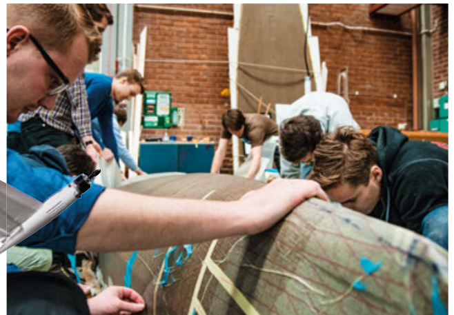
Formula Sailing är ett båtbyggeriprojekt och en tävling där 70 procent av skrovet måste bestå av biomaterial. Åtta studenter på Chalmers har jobbat med balsaträ, linneväv och en cashewnötbaserad epoxy – ett organiskt båtbygge.
