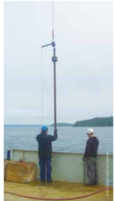
Den tre meter långa kolvlovsprovtagaren är redo för att ta ett sedimentprov från havsbotten i Stockholms skärgård.
