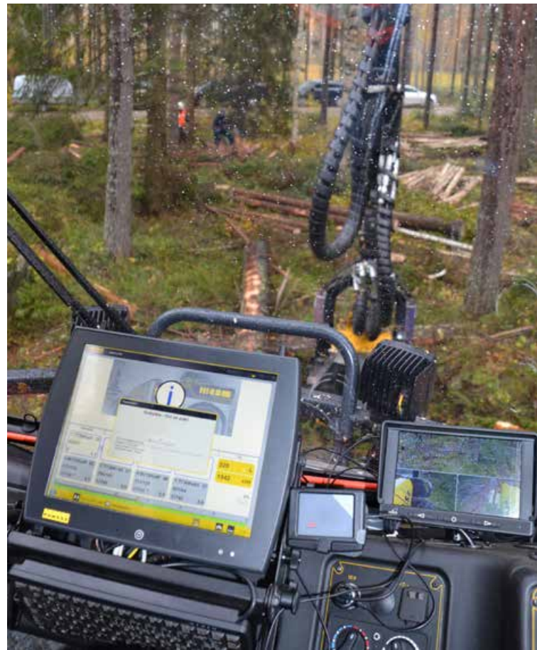
Löydätkö kuvasta tummiin vaatteisiin pukeutuneen toikkaroijan? Kuvan oikeassa alakulmassa on hakkuukoneen valvontakamerat, jotka omalta osaltaan auttavat kuljettajaa havaitsemaan vaaroja.
